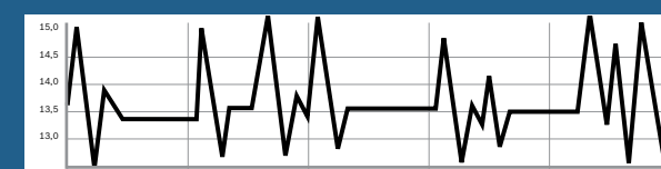
Wykres obciążenia akumulatora: pojazd ze Start/Stop i rekuperacją.
